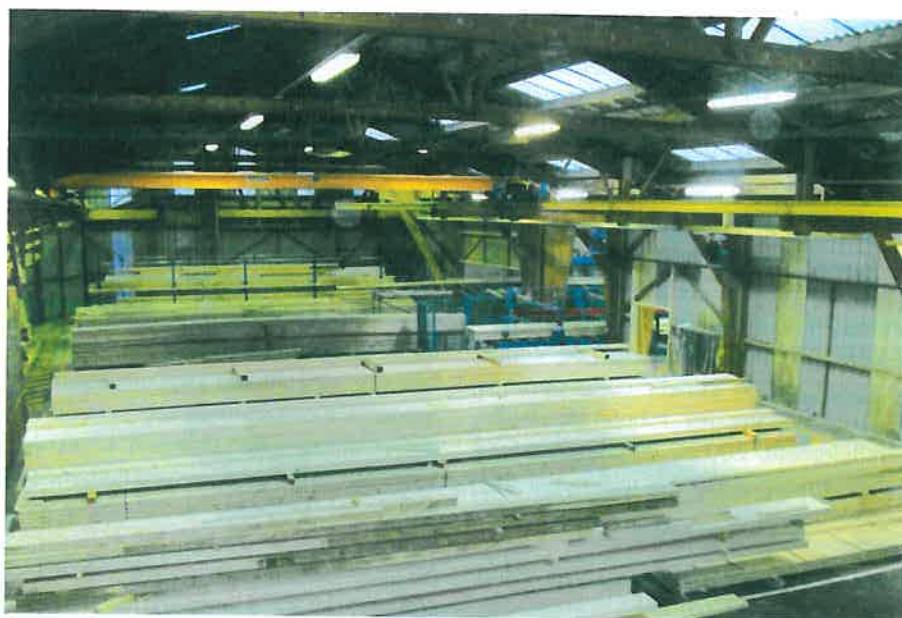
2.000 m 3 de bois aboutés, 90 m 3 de chêne et 1.000 m 3 de lamellé-collé prêts à l'usinage par les robots de taille sont stockés par an.
