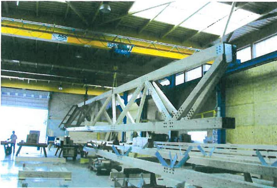
L'atelier d'assemblage de charpente comporte des équipements de levage.
